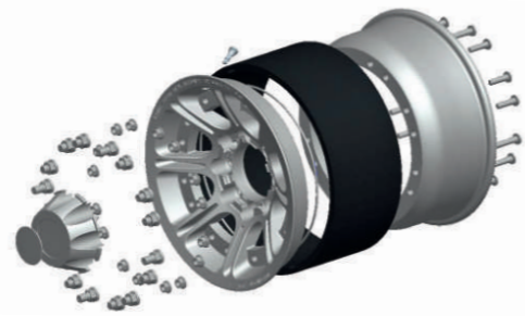
Rozkres kola Konstrukce kola HUTCHINSON s Beadlock-disky
